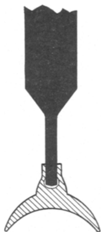
Fig. 1. Kohle-Elektrode in Kombination mit einer Haftschale (BORNSCHEIN, WICHTERLE und WÜNDSCHE 4 ). \varnothing des Stiftes an der Kontaktfläche ca. 2 mm.
